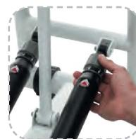
Сила нагрузки во время упражнений легко регулируется гидравлическими цилиндрами и выбирается из 6 уровней. Применение гидравлических цилиндров вместо металлических грузов, обеспечивает плавность нарастания и спада усилия во время движений, исключает инерционные нагрузки на суставы, создавая щадящий режим для их работы.
